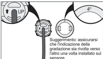
Suggerimento: assicurarsi che l'indicazione della gradazione sia rivolta verso l'altro una volta installato sul sensore
